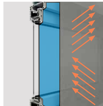
Außenliegender Sonnenschutz wirkt effektiv: Die Reflexion der Sonneneinstrahlung liegt bei vielen Geweben über 60 %.
